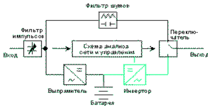
Рис. 9. Работа ИБП с переключением от сети
